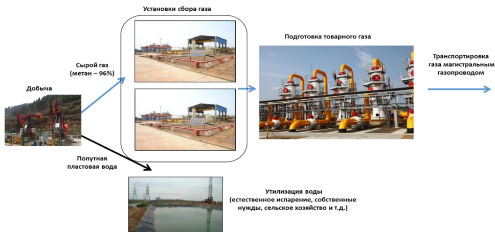
Рисунок 2 – Инфраструктура добычи угольного метана на участке Вейбей (г. Ханчэн, провинция Шанси) [20]
